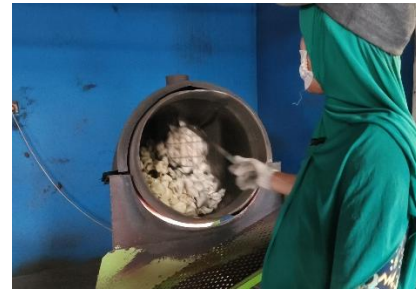
Gambar 7. Penggorengan menggunakan pasir
