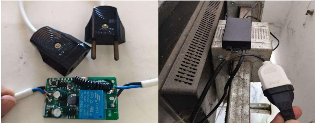
Gambar 4. Hasil implementasi relay wireless pada node meja TV
